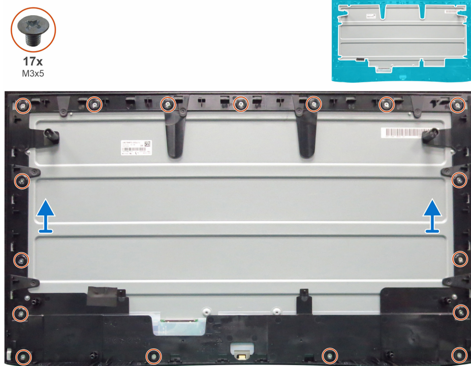
Figura 12. Rimozione del telaio centrale per il modello S2725HSM
