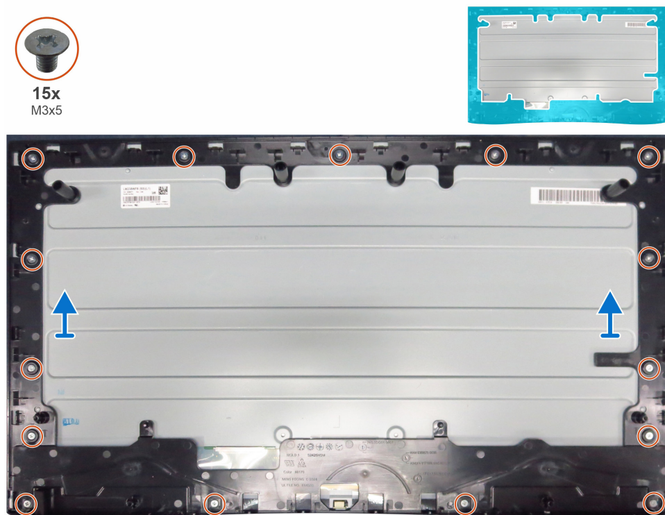
Figura 11. Rimozione del telaio centrale per il modello S2425HSM
